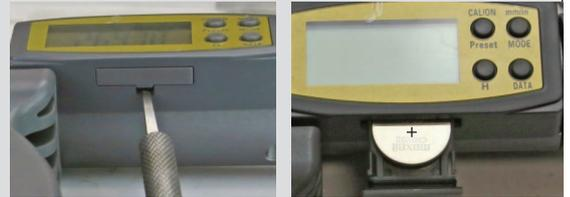
**Bei Herausnahme der Batterie kann es passieren, dass die Batterie im Gehäuse bleibt. In diesem Fall das Batteriefach leicht nach unten drücken und herausziehen.**
